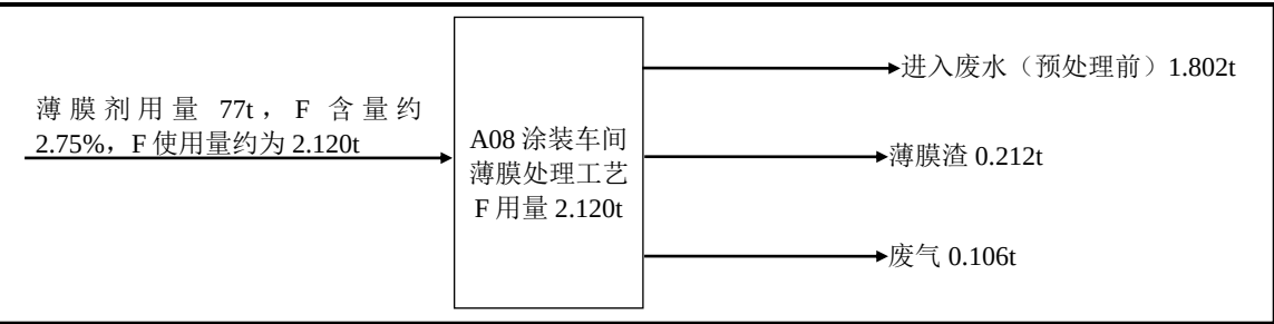
图 4-2-5 项目实施前 A08 涂装车间氟（F）物料平衡图单位：t/a
