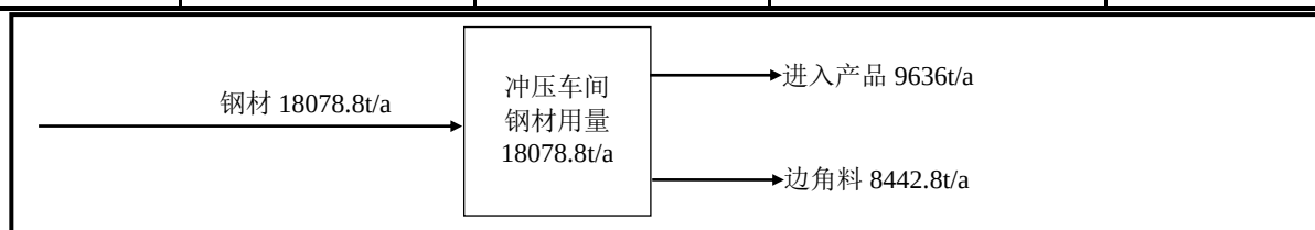
图 4-2-2 项目实施后 A08 冲压车间钢材物料平衡图 单位：t/a
